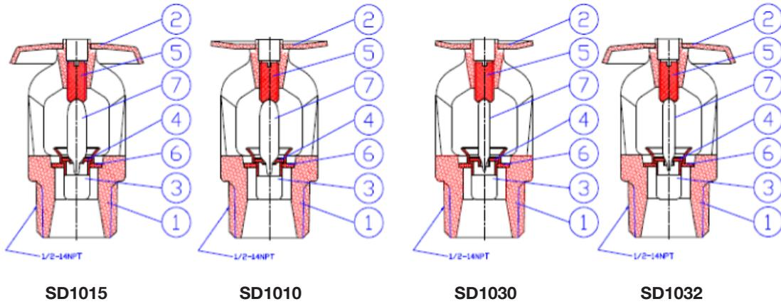
1. Frame      2. Deflector      3. Cap      4. Cap Seat      5. Load Screw      6. Seal      7. Bulb
